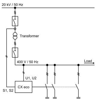
Реактивная мощность, создаваемая трансформатором, измеряется измерением тока среднего напряжения и компенсируется подключенной системой компенсации.
