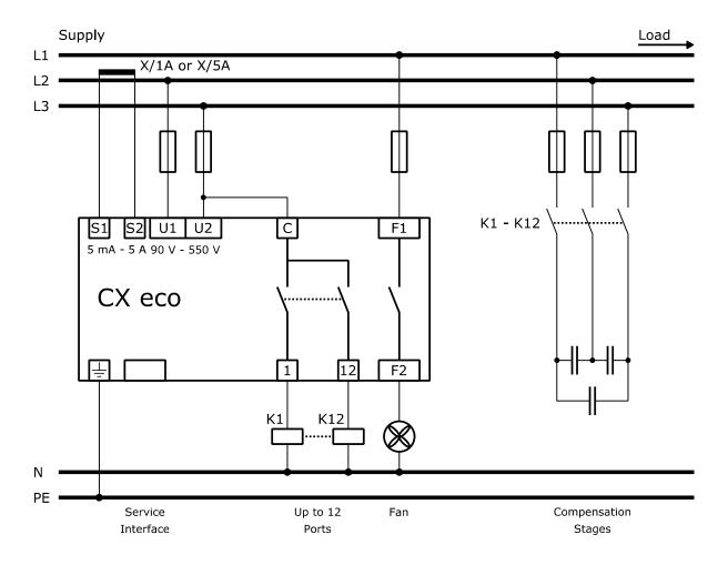
**Примечание:** СХ есо предназначен для управления емкостными или индуктивными ступенями. Одновременная работа обоих типов ступеней невозможна.
