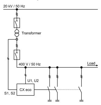
Если нет доступных статических ступеней для компенсации вышестоящего трансформатора, это можно сделать с помощью управления СХ есо.
